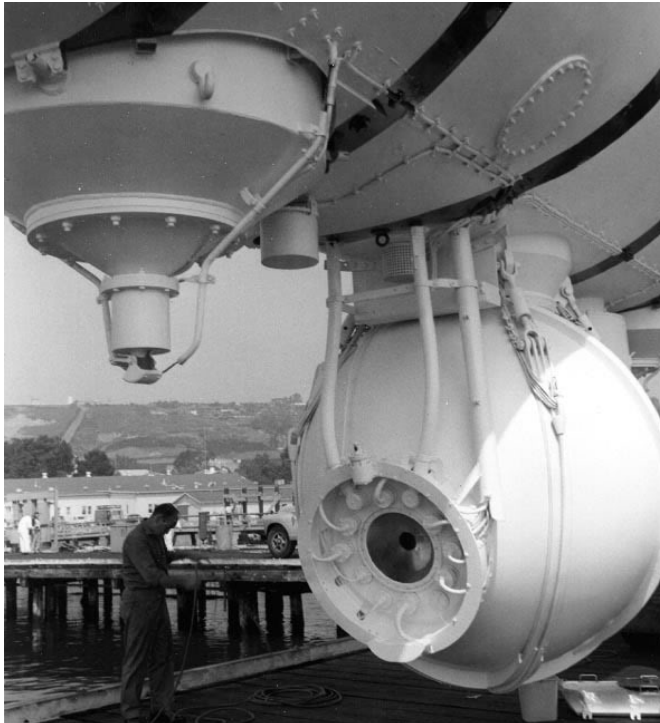
Fotografía anterior a la inmersión más profunda que muestra la parte inferior del batiscafo Trieste con su esfera y la ventana de observación.
